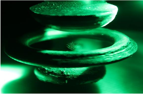
(a) Bälappsporen in der Falle bei einer Primärspannung von etwa 10 V.
