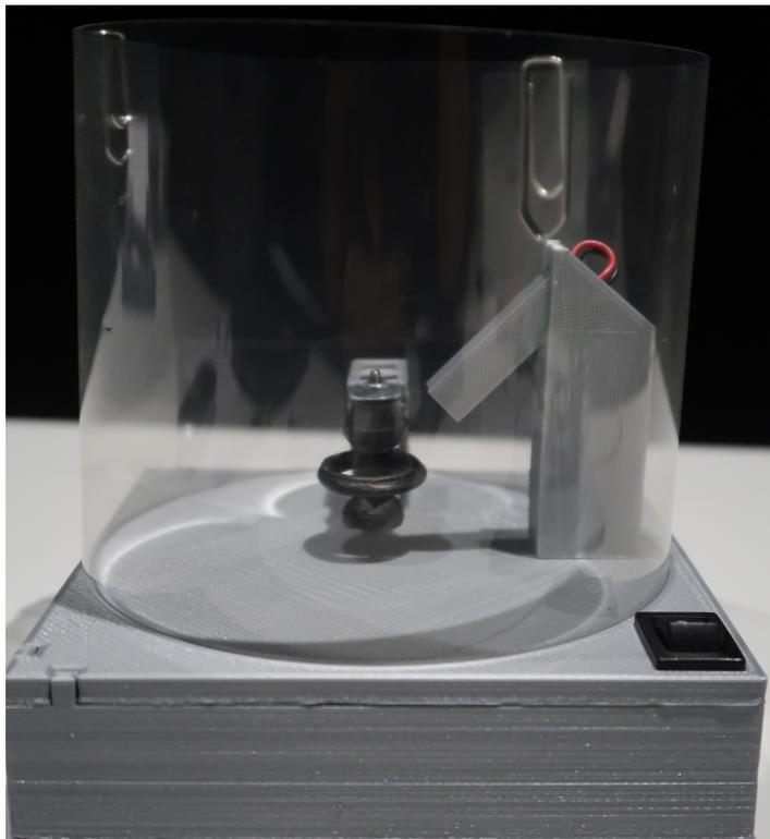
**Abb. 3.5.:** Die Falle mit Strömungsschutz aus Tageslichtprojektor-Folie.
