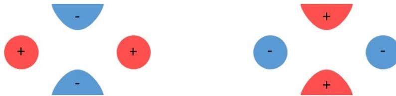
**Abb. 4.1.:** Ladungszustände der Elektroden
