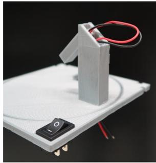
5. Schwarzes Kabel der LED an den Schalter löten.
