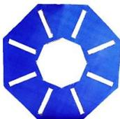
Mit Hilfe der blauen Vorlage wird nun die Halterung für die acht Spulen gefertigt. Dafür wird das Papier wieder ausgedruckt und auf einen Karton geklebt. Danach werden alle weißen Stellen mit einem Cutter entfernt.
