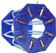
Mit Hilfe eines Feuerzeugs und/oder Sandpapiers kann nun die Isolierung an den Enden des Kupferdrahts entfernt werden. Anschließend wird das äußere Drahtende einer Spule mit dem inneren Drahtende der benachbarten Spule verdreht. Am Ende sollten noch zwei Drahtenden unverdreht bleiben, um diese mit der Spannungsversorgung zu verbinden.
